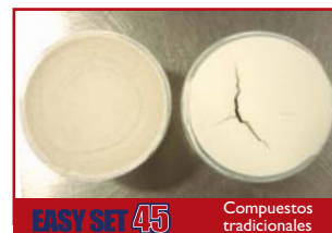
Grado de agrietamiento con espesores altos.
